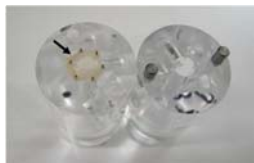
Рис. 3. Схема и фотография камеры Уссинга для изучения электрофизиологических характеристик и барьерных свойств кишечного эпителия.
