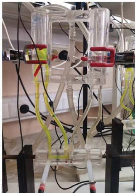
Рис. 3. Схема и фотография камеры Уссинга для изучения электрофизиологических характеристик и барьерных свойств кишечного эпителия.
